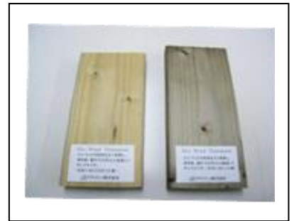
右：塗布後陽にあたる場所に設置したSPF 左：塗布後日陰に設置したSPF
